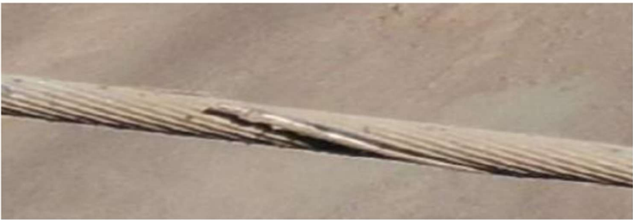
Ilustración 1 Registro de agosto 2025, hebras cortadas en conductor
