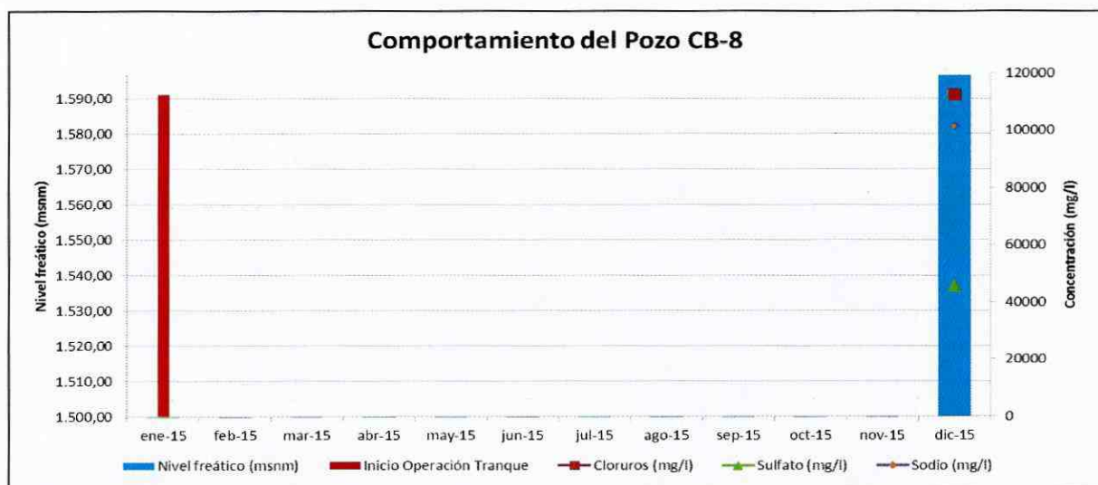
Figura 4. Evolución del nivel freático y calidad química del pozo CB-8 del periodo Enero a Diciembre de 2015.
