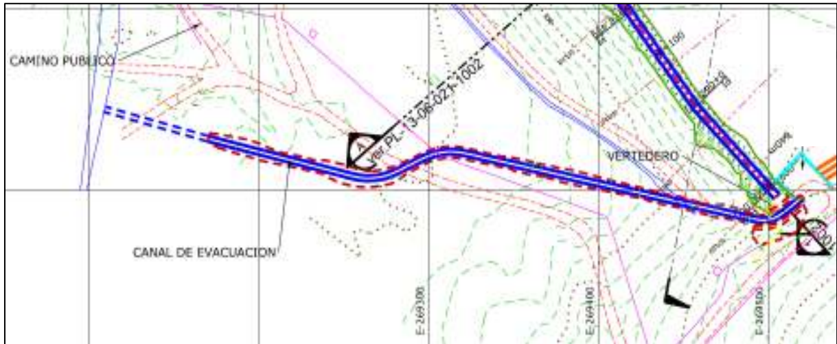
Figura N°2. Punto del vertedero y canal de evacuación.
