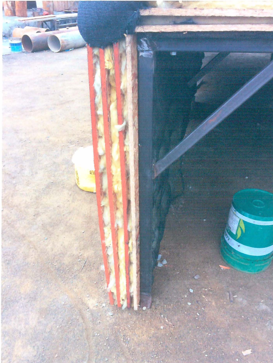
Fotografía 6: Capas de encierros acústicos fijo y móvil para martinete Delmag-D12.
