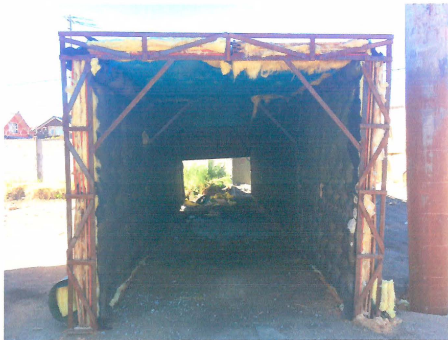
Fotografía 8: Encierro acústico móvil martinete Delmag D-12, h=9.60 m.
