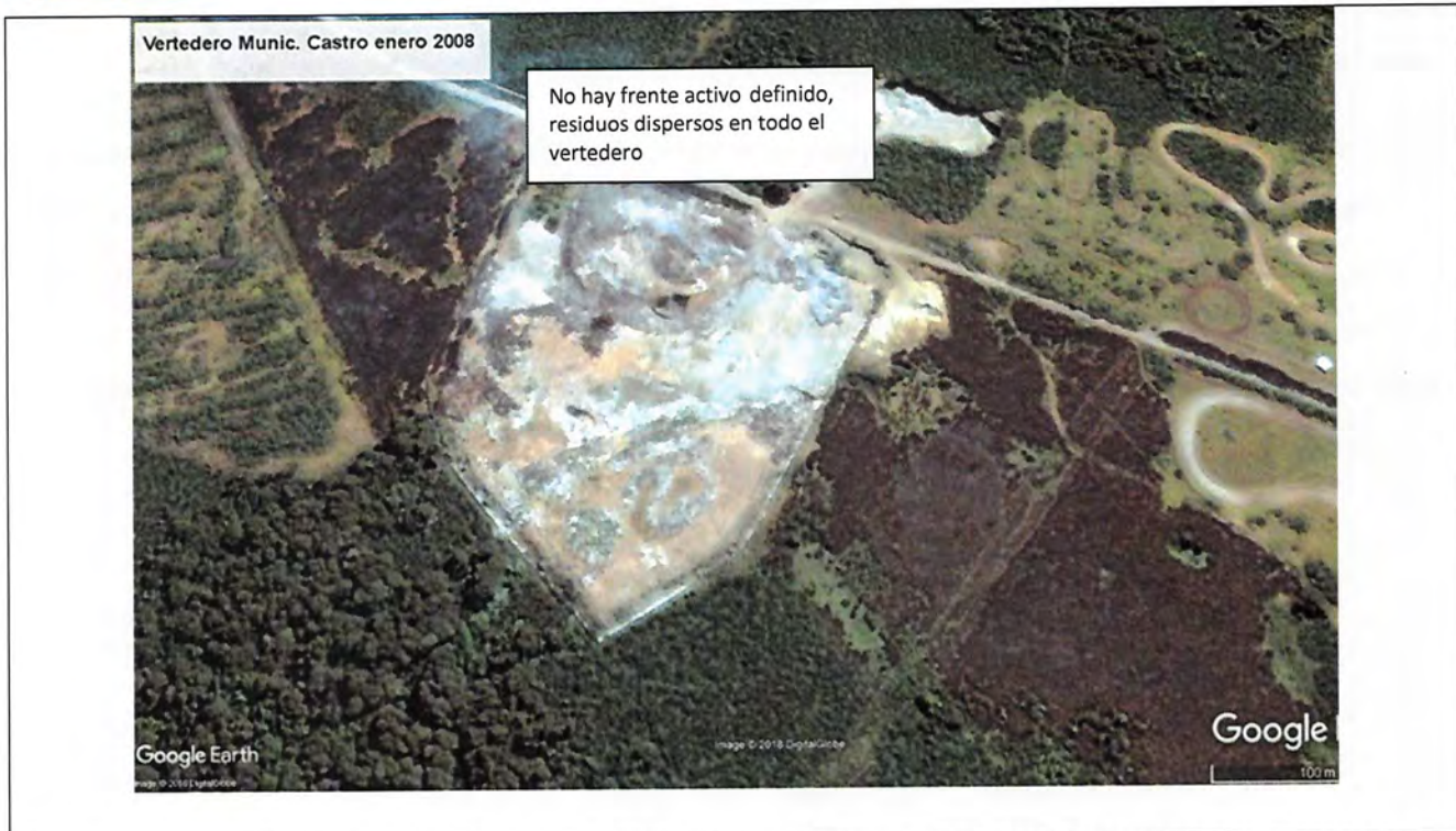
Fotografía 24: Es previa a la RCA 453/2009, confirma lo indicado en la DIA "La operación del vertedero se ha desarrollado hasta la fecha por el método de área, la conformación en junio 2008, es la de un vertedero a cielo abierto".
