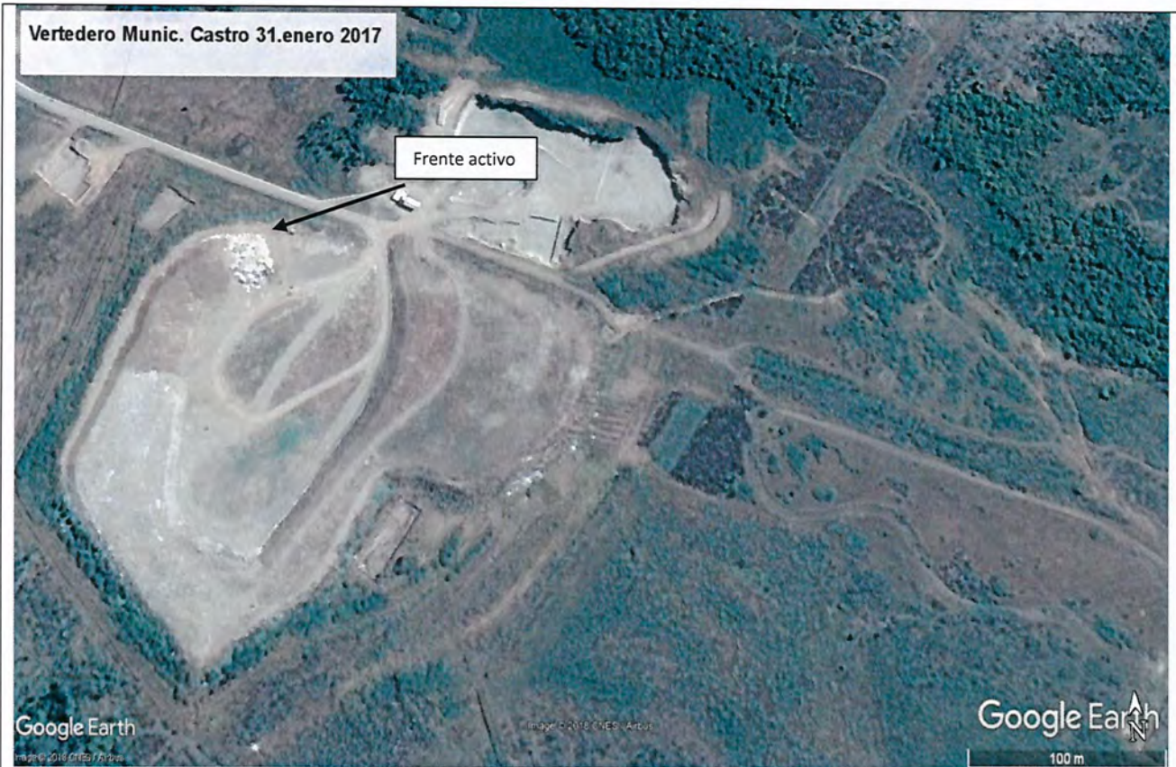
Imagen 26: Se observa un nuevo frente de disposición de residuos, los cuales son incorporados en zona que según DIA e imagen 25 correspondiente al 2011, era un área cerrada.
