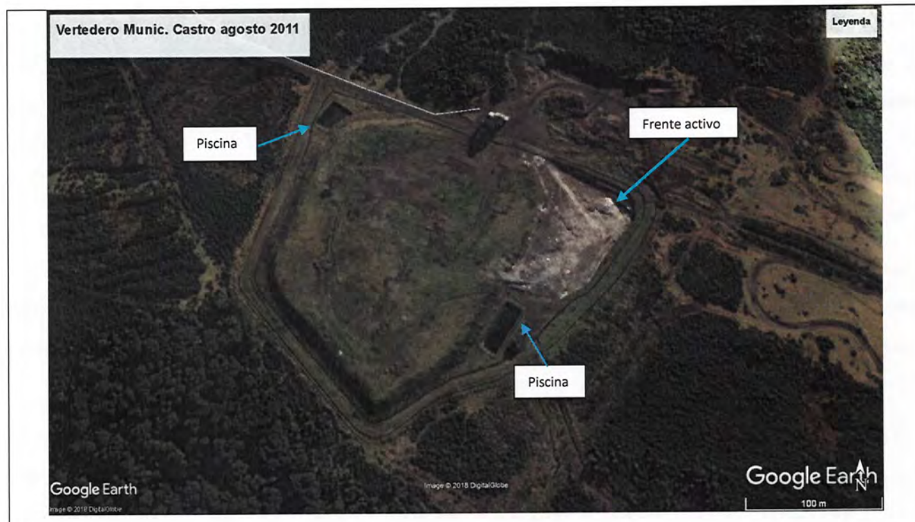
Imagen 25: Es posible observar un frente activo determinado y 2 piscinas de lixiviados tal como se indica en DIA "Plan de cierre y sellado Vertedero comuna de Castro".
