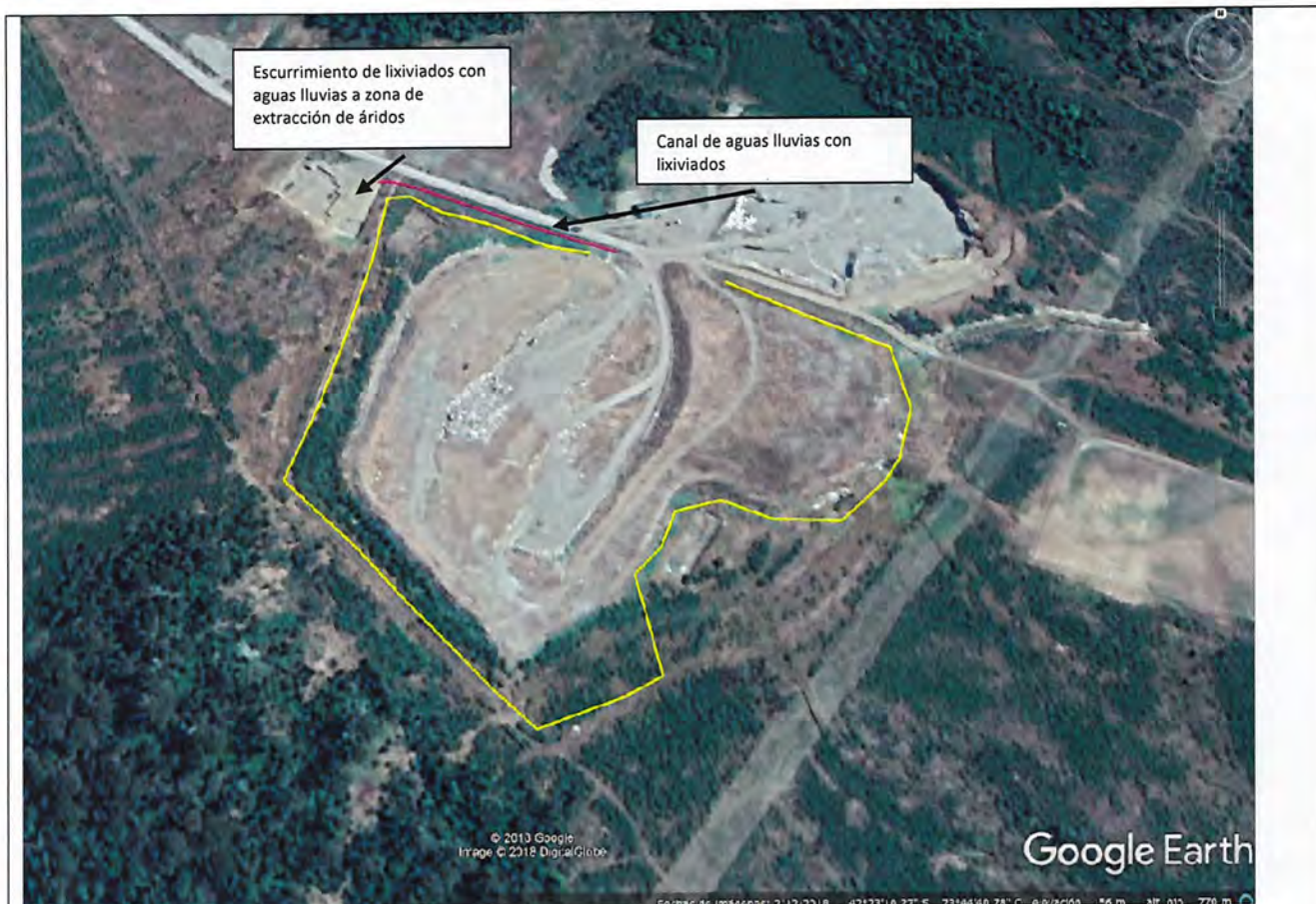
Imagen 28: Demarcación del canal de aguas lluvias que se mezcla con lixiviados y zona donde estos escurren por gravitación al área de extracción de áridos
