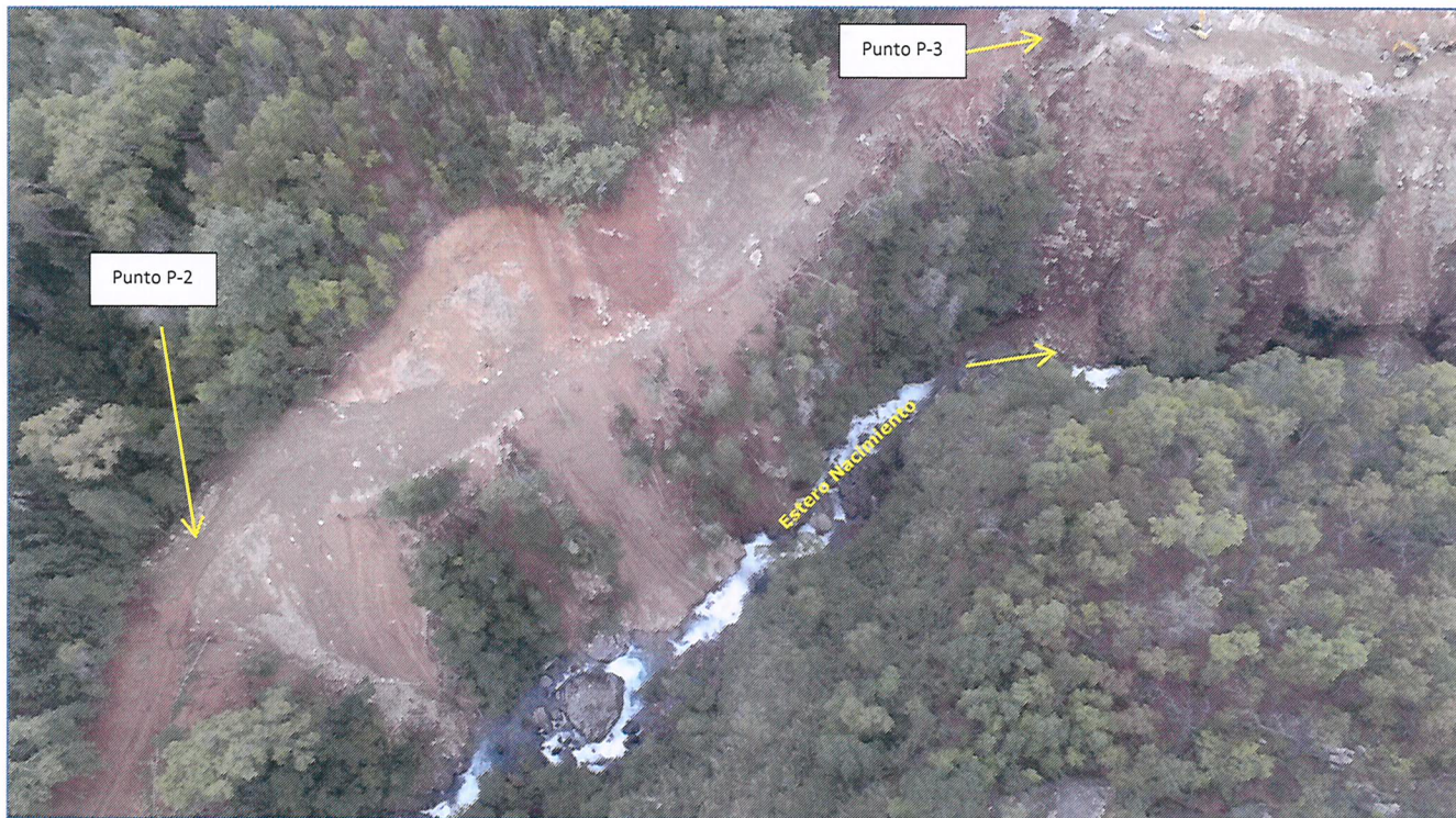
Fotografía N°3. Obstrucción de quebradas en P-2 y P-3.
