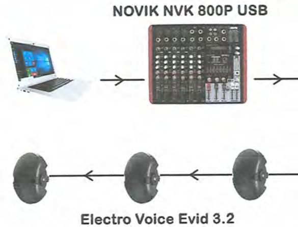
Figura 6. Sistema de sonido actual, Segundo piso, Pub Kunza.
