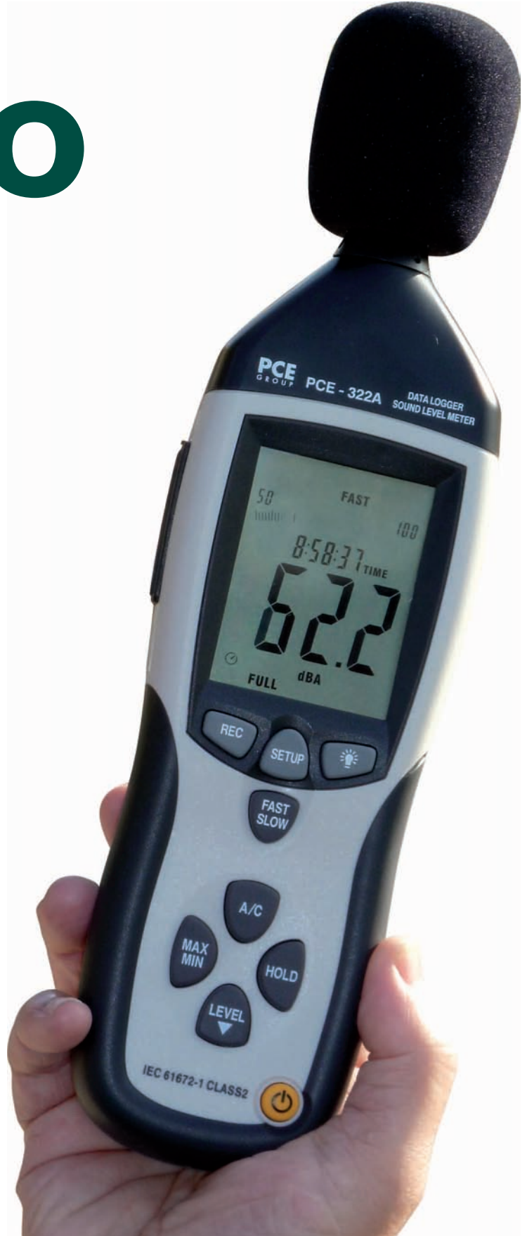
EL SONÓMETRO ES EL APARATO PARA MEDIR EL NIVEL DE PRESIÓN SONORA
