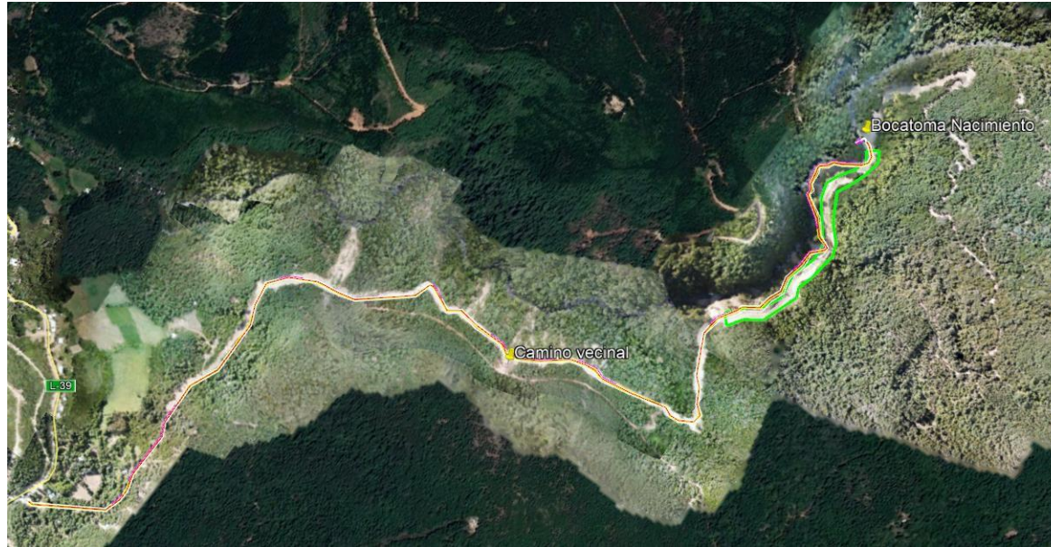
Figura 4. En verde, tramo en el que aún resta instalar la tubería.
