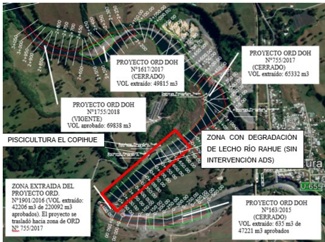
Figura 3 Zona con degradación cota de fondo río Rahue y zonas de proyectos ejecutados por la empresa Dowling % Schilling
