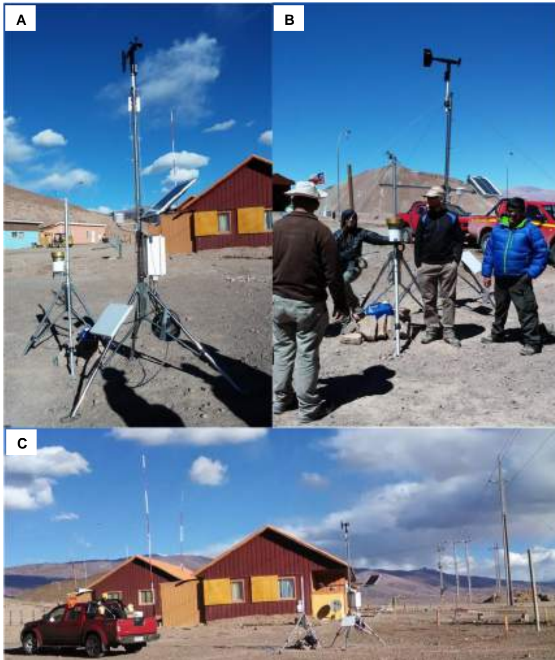
Figura 4.3. Fotografías tomadas tras la instalación de la estación meteorológica (C) y durante el desarrollo de las capacitaciones en terreno sobre el uso y operación de la estación meteorológica (A y B). Ambas actividades fueron desarrolladas en el terreno N°2.
