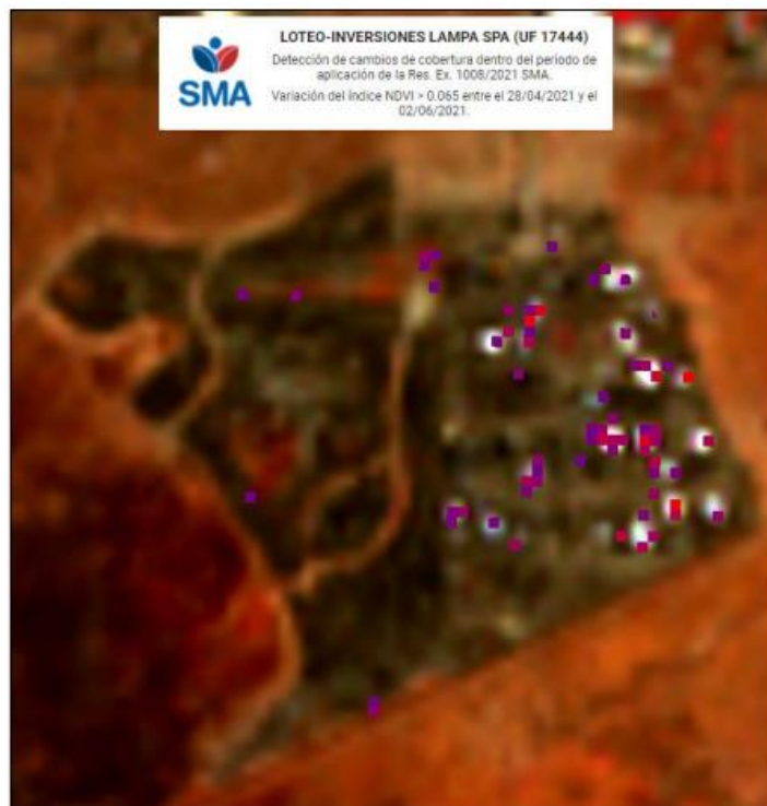
Figura 6. Detección de pérdidas de vegetación mediante variación del índice NDVI y levantamiento topográfico de perímetro
