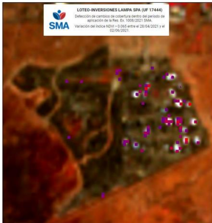
Figura 24. Detección de pérdidas de vegetación mediante variación del índice NDVI y levantamiento topográfico de perímetro.
