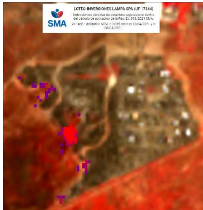
Figura N° 20. Detección de pérdidas de vegetación mediante variación del índice NDVI y levantamiento topográfico.
