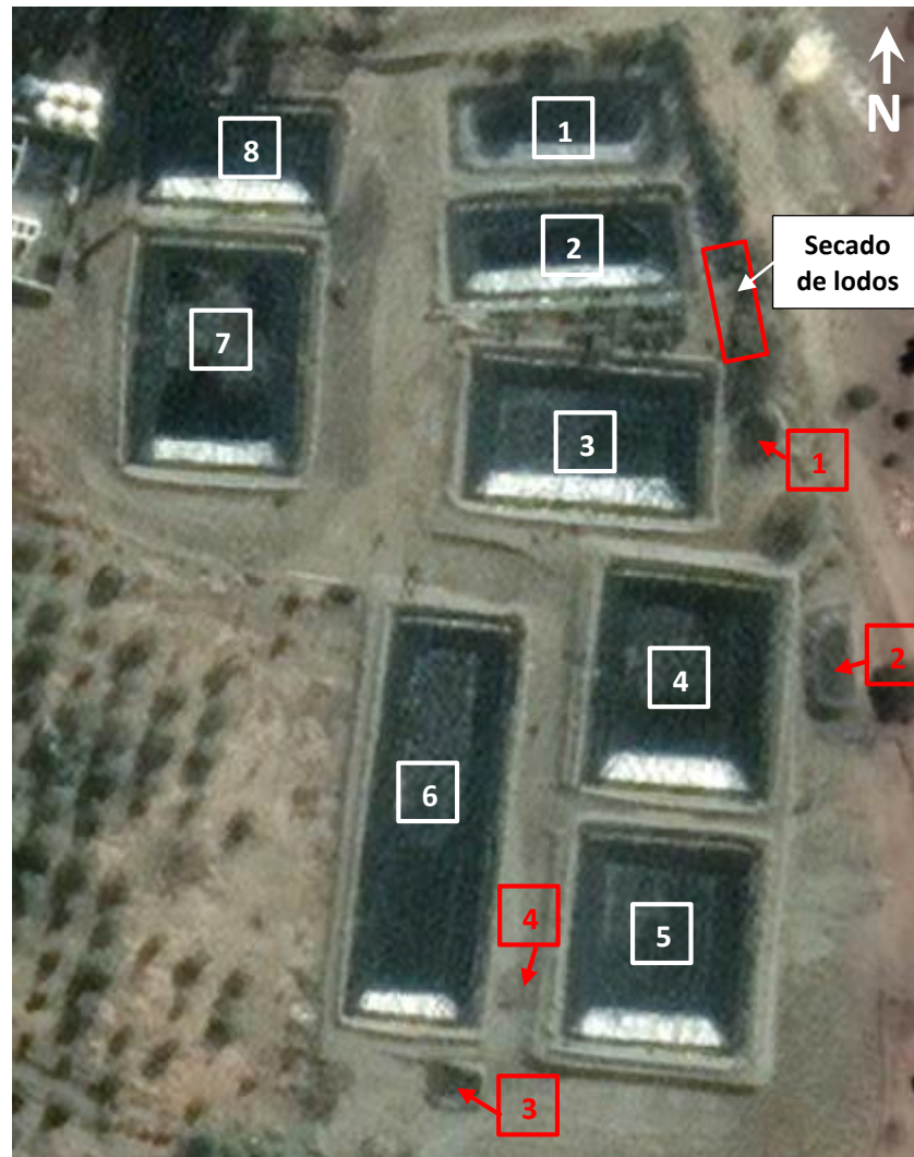
Figura 2. Zona de disposición final RILes y lodos. Piscinas de acumulación de RILes enumeradas (cuadro blanco), sector de secado de lodos y pozos de acumulación de lodos enumerados (cuadro rojo). (Fuente: Google Earth 2021, fechas de imágenes: 06/09/2021).
