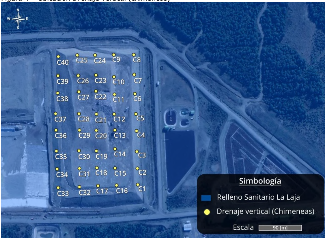
Figura 4 – Ubicación Drenaje vertical (chimeneas)
