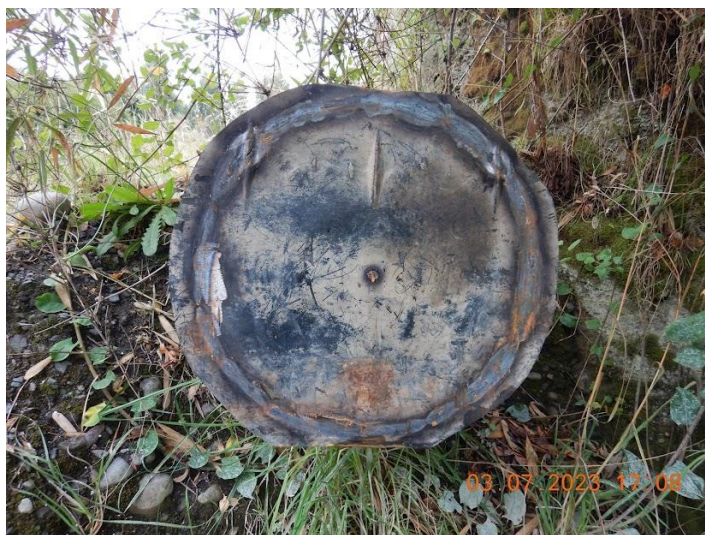
Fotografía 5: Tapa de hierro que permitió el sellado de la tubería de descarga, detalles de los trabajos de soldadura.
