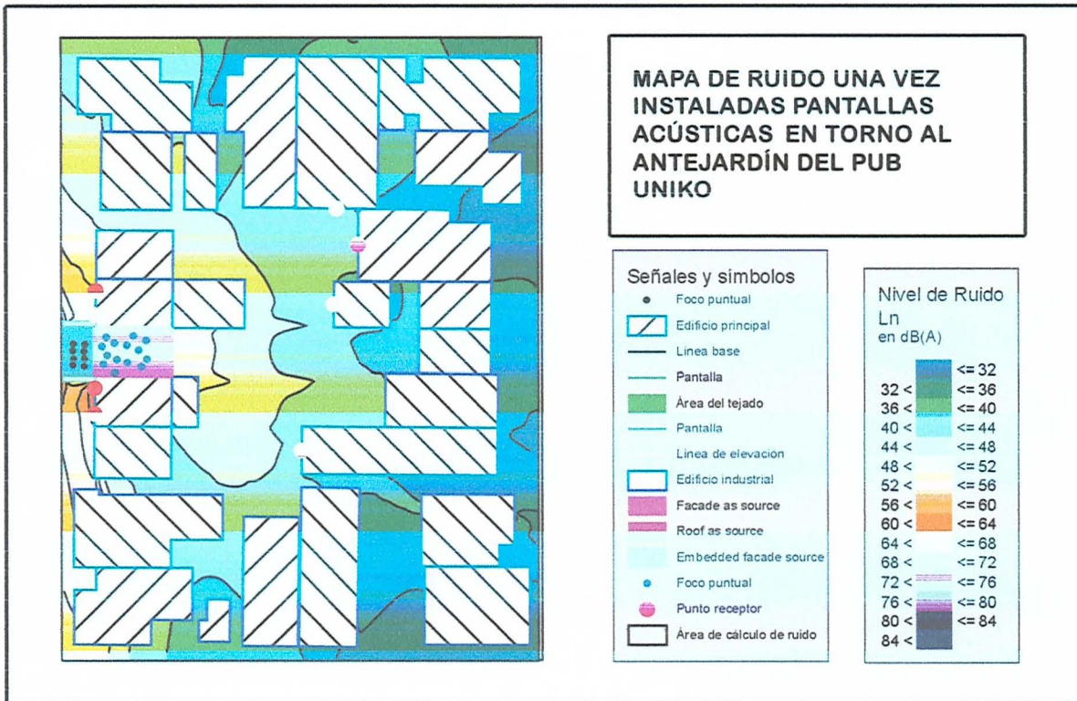
Figura 7. Mapa de ruido que se obtendrá con la instalación de pantallas acústicas.
