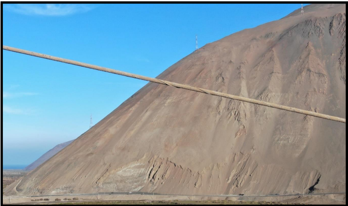
Imagen 77: 1 Hebra cortada en 2 puntos.
