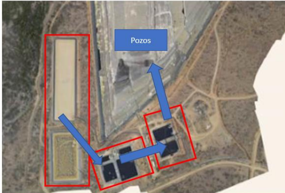
Figura N°2: Manejo de flujo de soluciones desde piscinas de emergencia hacia pozos
