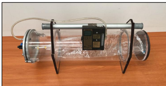
Bomba de vacío para toma de muestras.
