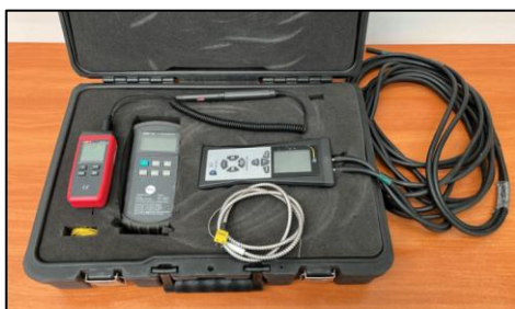
Diferencial de presión, termómetro e higrómetro.
