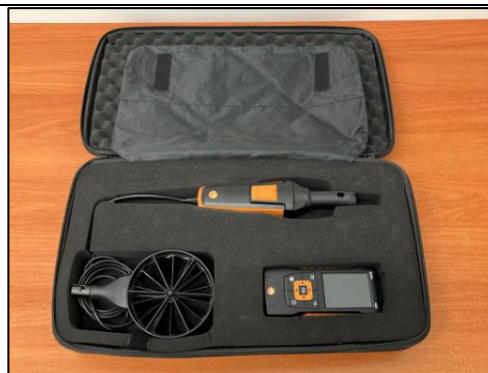
Anemómetro de paleta para medición de flujos.
