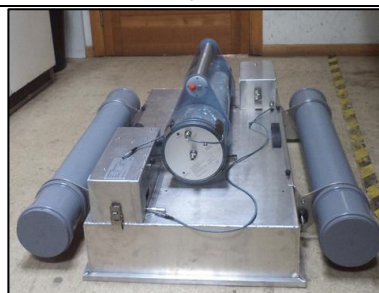
Campana ventilada para muestreo en fuentes de área pasiva.
