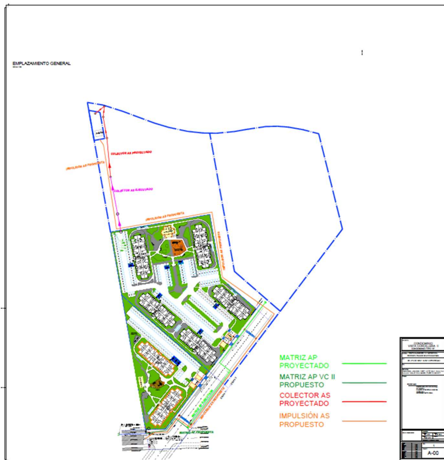
Imagen N° 5: Proyecto de agua potable y aguas servidas Vista Cordillera I y II.
