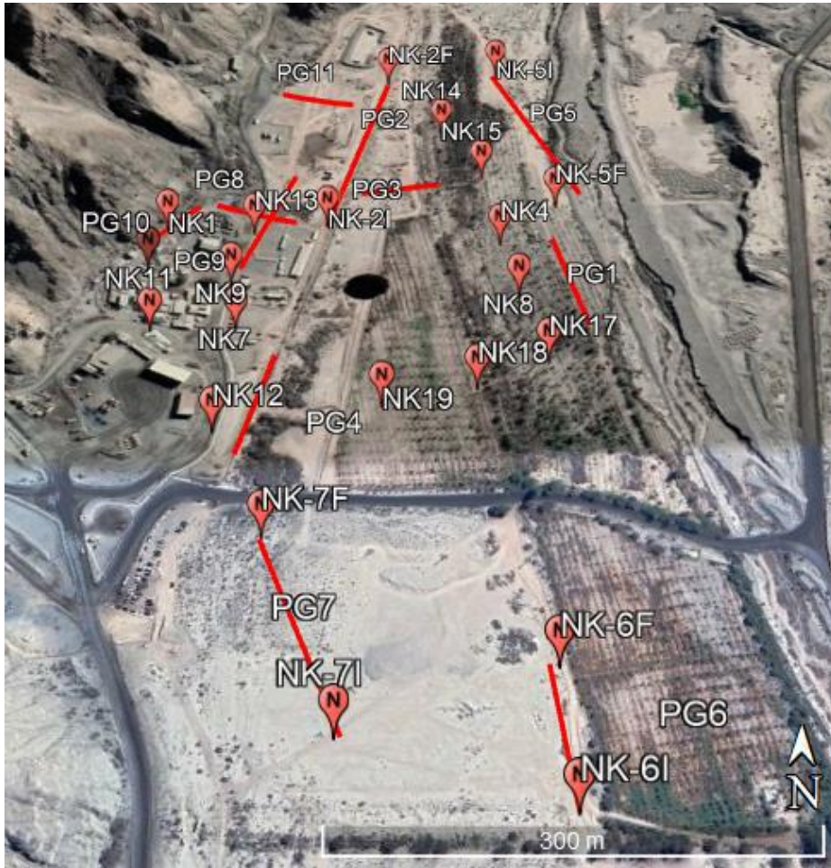
Figura N°2 distribución planta ensayos geofísicos Idiem, 2022
