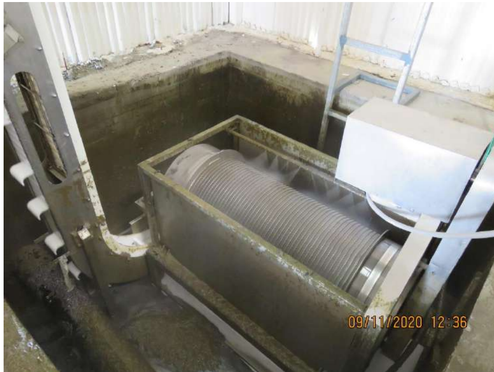
Fig. 9. Filtro rotatorio autolimpiante
