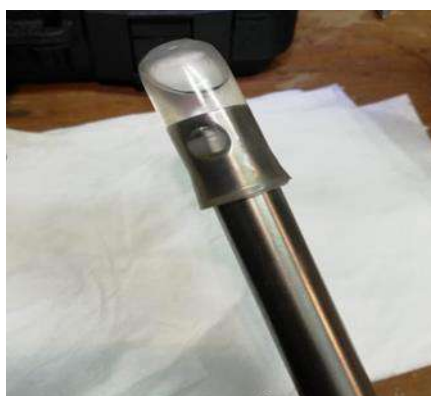
Figura 2 Electrodo con buffer de almacenamiento
