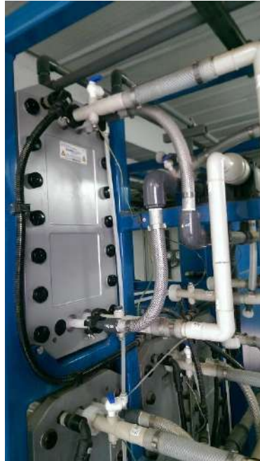
Ilustración 1: Estado Inicial EDI (Stack nuevo)
