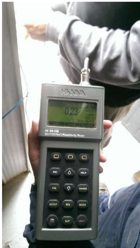
Ilustración 4: Conductividad agua producto, después de 4 horas con P.A.D en servicio
