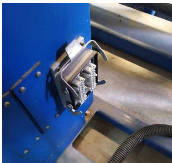
Ilustración 1 Desconexión desde el rectificador
