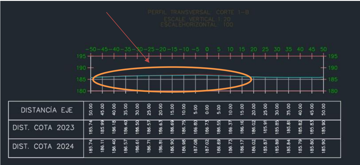
FIGURA 16. PERFIL TRANSVERSAL 1-B
