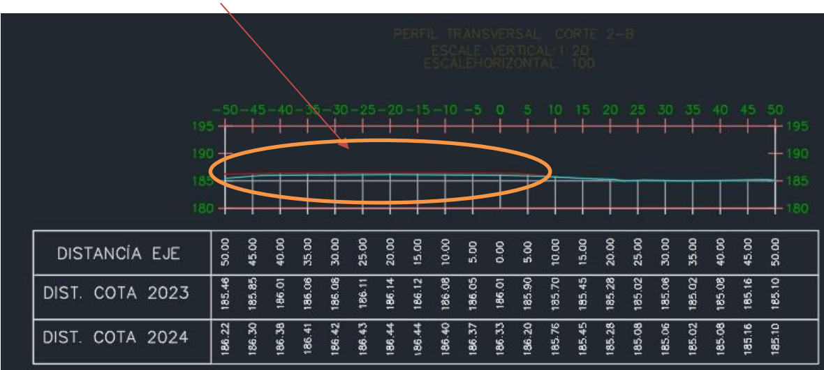
FIGURA 17. PERFIL TRANSVERSAL 2-B
