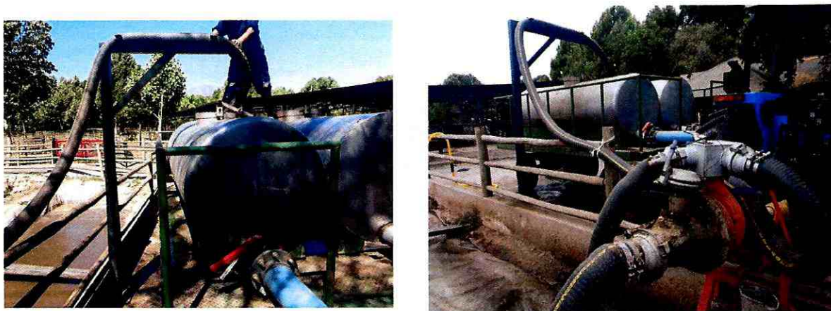
Figura 6. Succión de la fracción líquida de Purines (Barridos) de Patios de Espera desde Pozo Purinero hacia carro aljibe
