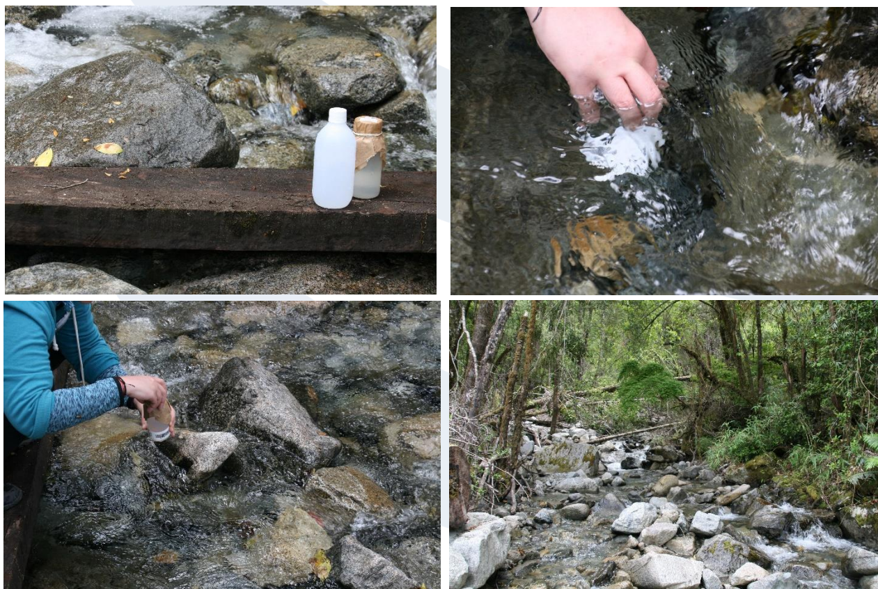
Figura 4. Medición in situ de parámetros ambientales y toma de muestras de agua para análisis en laboratorio
