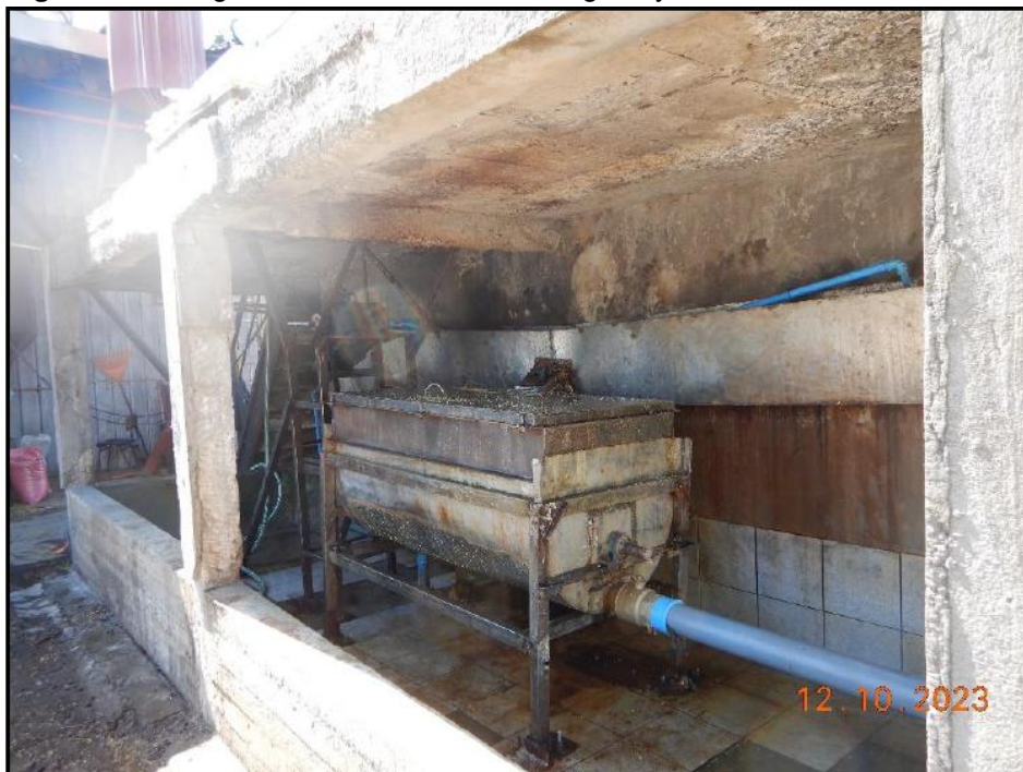
Imagen N°15: Registro del sistema de centrifugado y lavado del mote una vez cocido.
