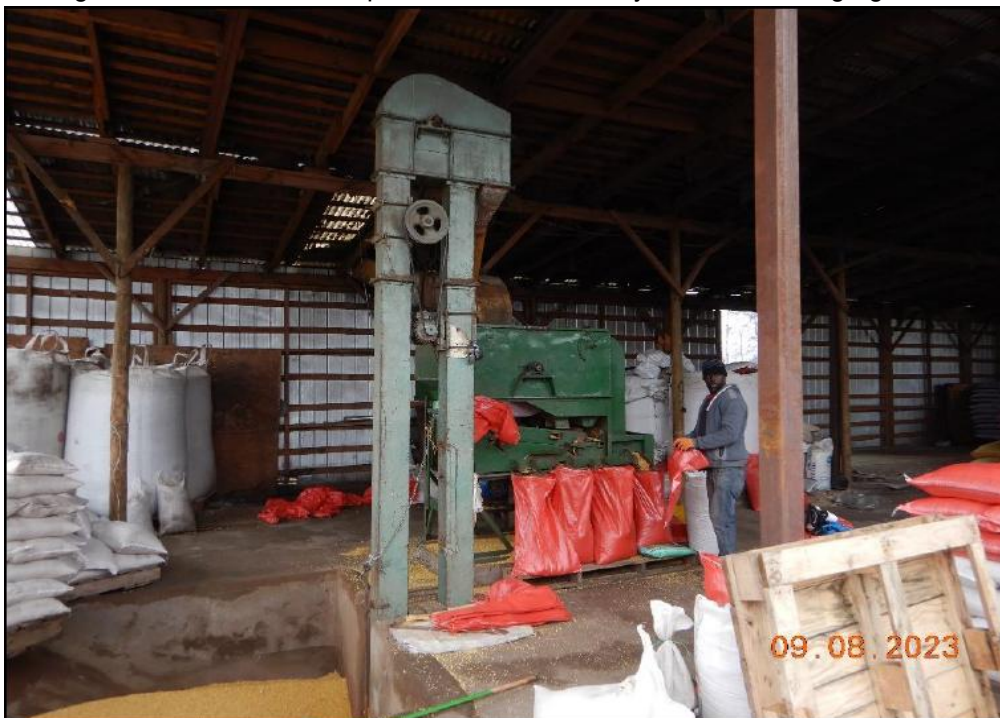
Imagen N°3: Equipo que permite separar los granos de trigo según la granulometría del grano, los cuales son dispuestos en sacos de nylon en forma segregada.
