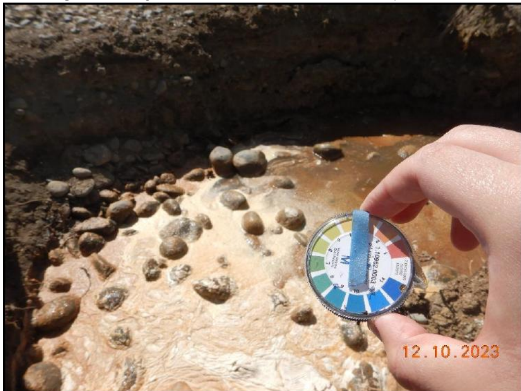
Imagen N°11: Registro del valor obtenido de la medición de pH del efluente.
