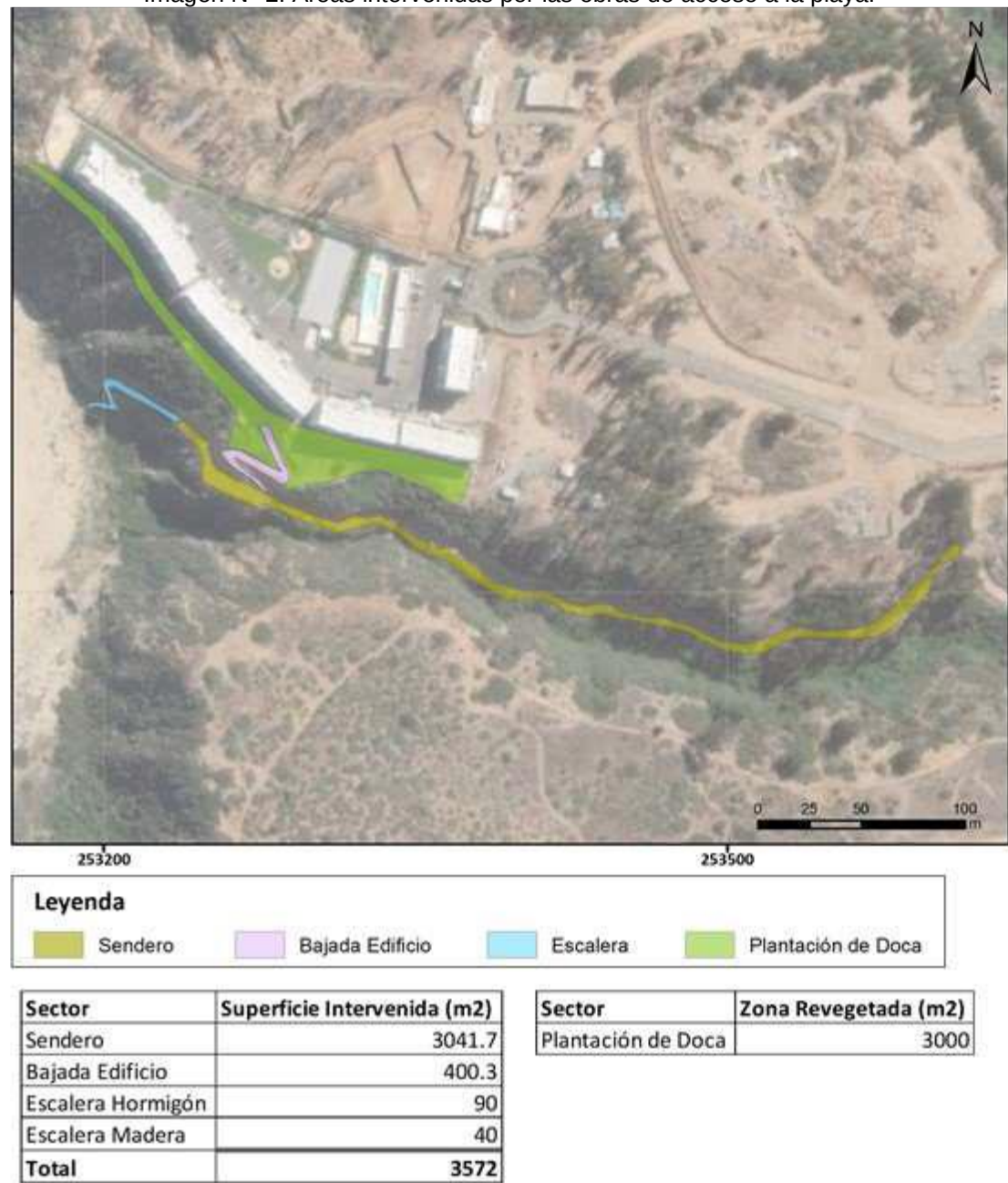
Imagen N° 2: Áreas intervenidas por las obras de acceso a la playa.
