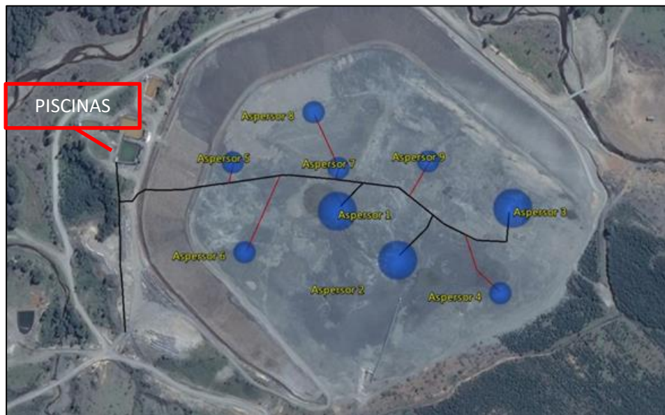
Figura N°1: Recirculación de agua y aspersion
