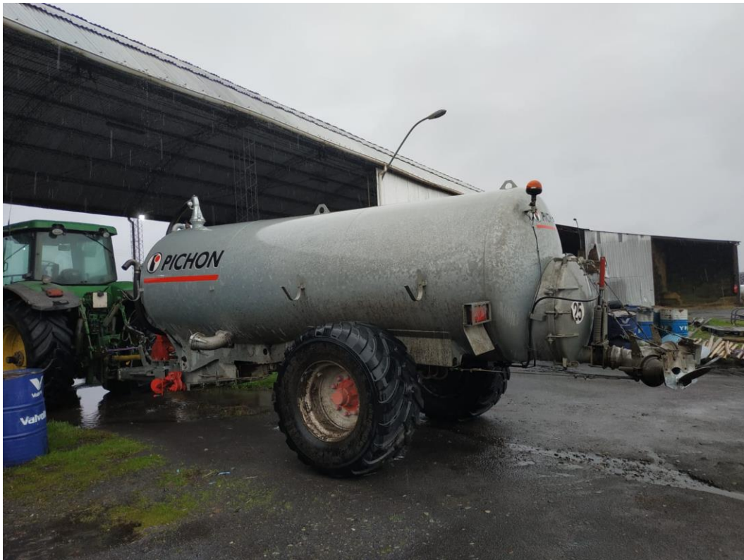
Figura 15. Carro Purinero para fertilización de cultivos.
