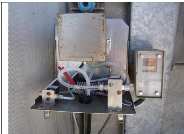
Fig. 1: Sonda de gases sin cubierta
