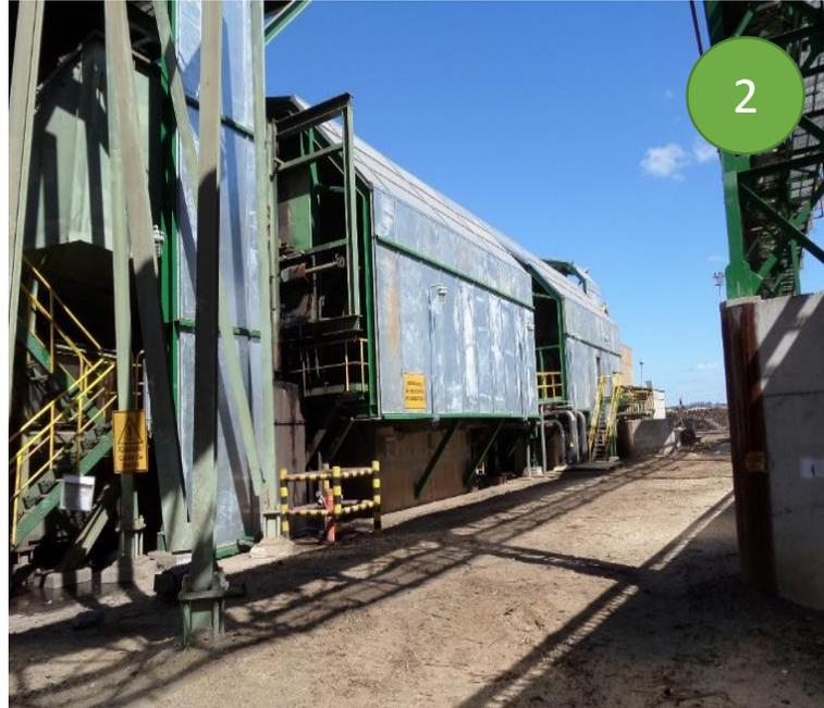
2.- Encierro de la Línea 1 de Proceso (Astillador y Descortezador) con paneles acústicos y revestimiento interno de material absorbente
