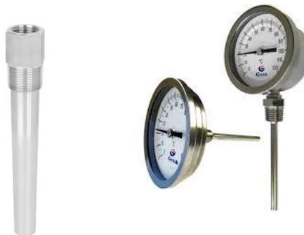
**Termowell:** son accesorios tubulares utilizados para proteger sensores de temperatura instalados en procesos industriales, consiste en un tubo cerrado en un extremo y montado en la corriente del proceso
