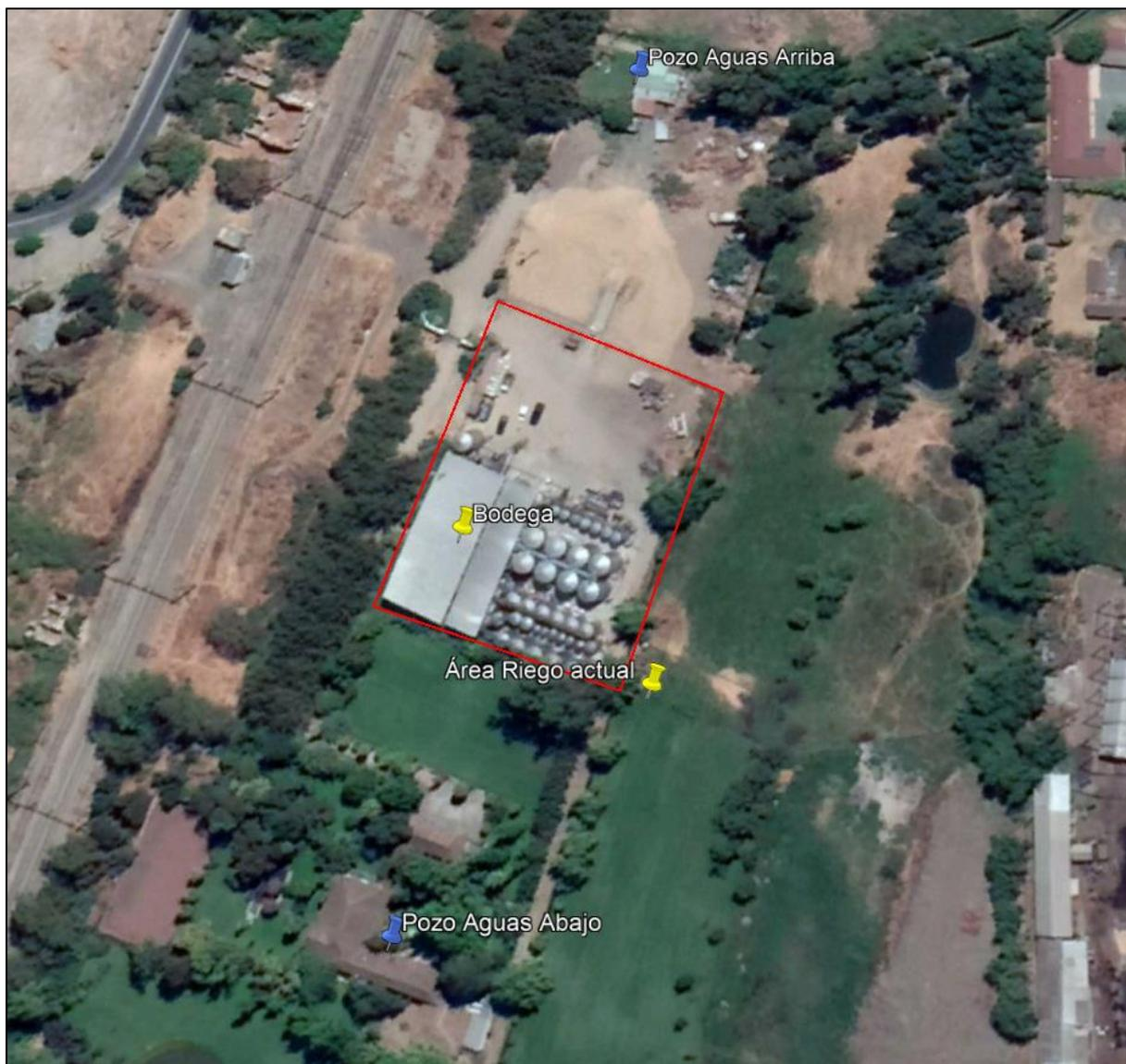
Figura 8. Ubicación de pozos para el monitoreo de aguas subterráneas. Fuente: Elaboración propia en base a coordenadas tomadas por ETFA.
