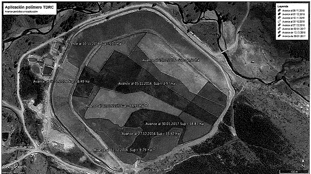
Figura 3. Avance de los trabajos de aplicación de floculante para control de polvo.
